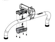
8、可将V口供电底座或安东口供电底座安装至下环臂供电口位置处螺丝锁紧即可。可以实现超续航不间断供电。 (洗配)
