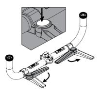
2、对准限位柱,将两个手柄分别装至环形手持-下臂 逆时针方向转动旋钮,锁紧手柄。
