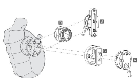
(A) 搭配DJI Ronin 4D燕尾接驳件使用 Use with the DJI Ronin 4D Attachment
