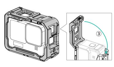
按压装机按钮①并打开侧边翻盖②,将运动相机装进全笼中, 合上翻盖③完成装配。
