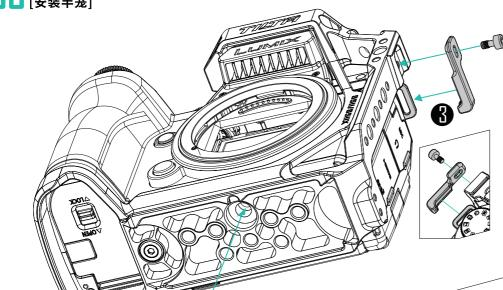
1.将相机装入松下S5 II/IIX半笼①, 取出 底部的一字扳手②,将一字螺丝锁进笼子 底部的安装孔上。
